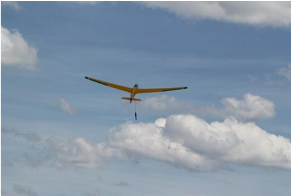
Largage du câble, qui redescend, freiné par un parachute
